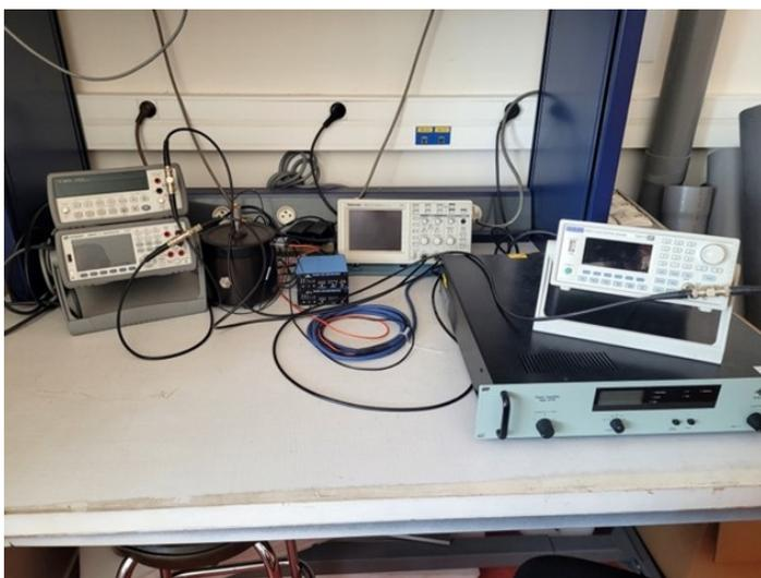
Poste de TP d'étalonnage d'accéléromètre
