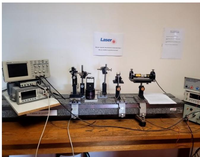
Box d'optique pour le TP d'étude d'un capteur de position
